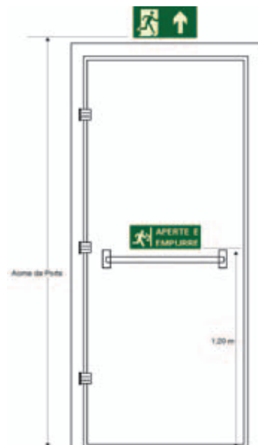
Sinalização de portas com barras antipânico
