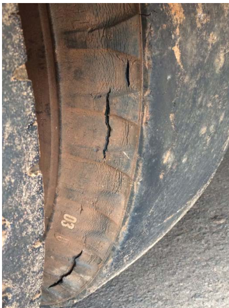
Altair – pneus em péssimo estado
